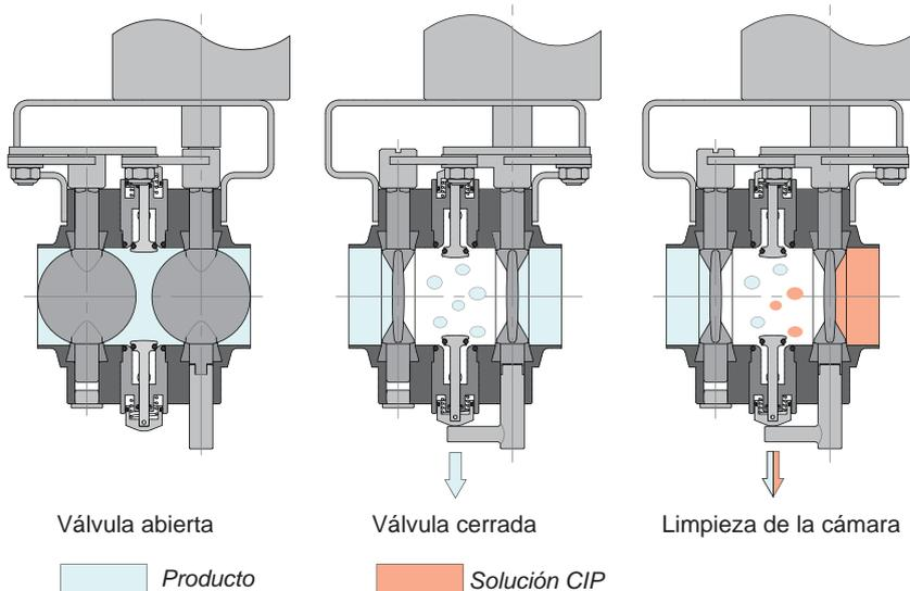
Cuando las dos válvulas están cerradas se crea una cámara entre medio que al estar conectada al exterior se mantiene a presión atmosférica y de esta manera con cualquier fallo de alguna de las dos juntas se detectaría la posible mezcla de productos con una fuga de líquido hacia el exterior.
